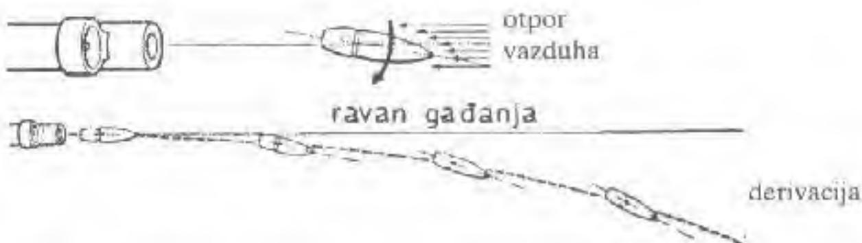
Derivacija. Cijevi sa uvijanjem žljebova u desnu stranu izazivaju odstupanje putanje zrna u desno.
